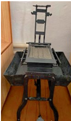
Werkzeugmaschine für die Verarbeitung der Dachschindeln im Museum
