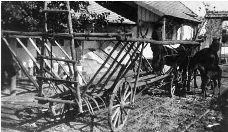
Die Verbindungsstange zwischen Vorder- und Hinterräder konnte ausgetauscht (Kurz- und Langwied) und so der **Achsabstand** variiert werden. In wenigen Handgriffen entstand aus dem Trogwagen ein **Leiterwagen – Harbie**.
