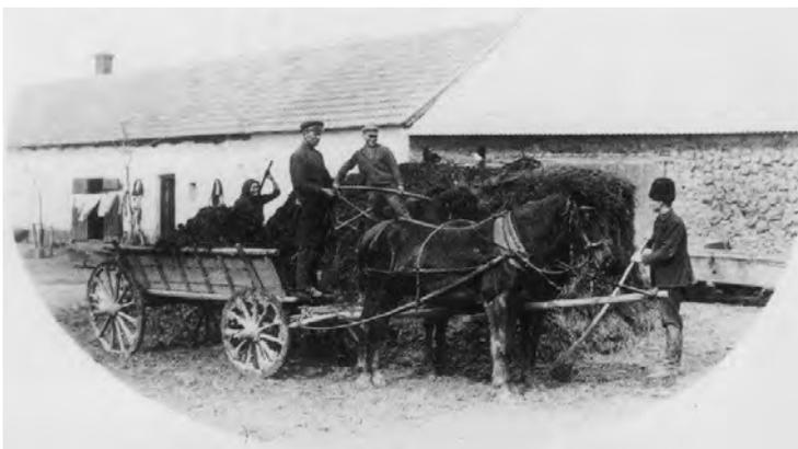
Ersetzte man den Trog durch einen Kasten mit hochziehbaren Seitenteilen, wurde daraus ein **Kastenwagen**. (Mist, Erde, Sand). Zog man die Seitenteile hoch, fiel die Ladung seitlich herunter
