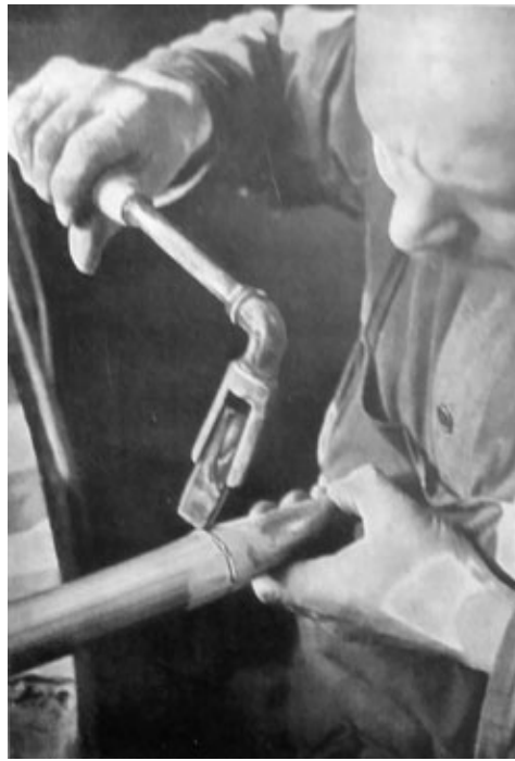
Zusammenlöten von Fuß und Pfeifenkörper
